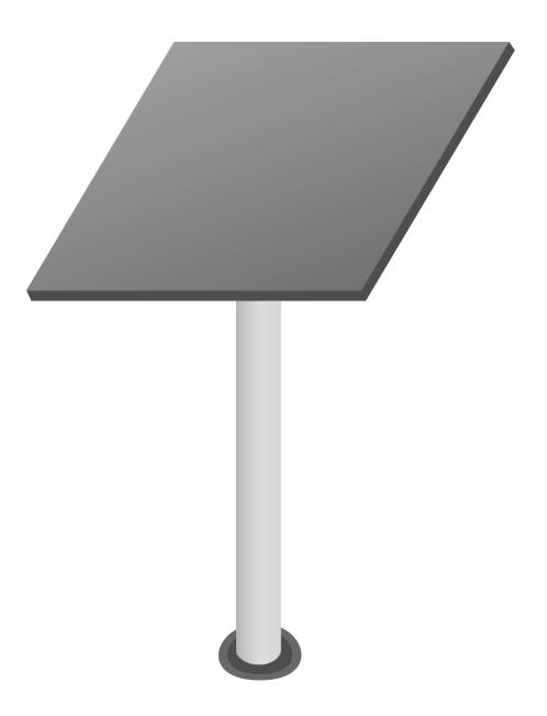
Стойка для тактильной таблички на опоре. Для уличного размещения. Материал изготовления — нержавеющая стальная труба, D42 мм. Регулируемый угол наклона. Высота-1100 мм
