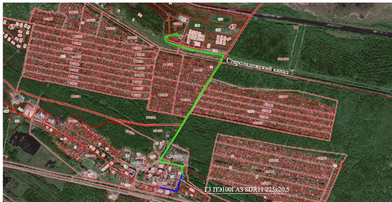
Рис. 9. Трасса нового отрезка газопровода от пос. Синявино через Староладожский канал в г. Шлиссельбург (предоставлено заказчиком).
