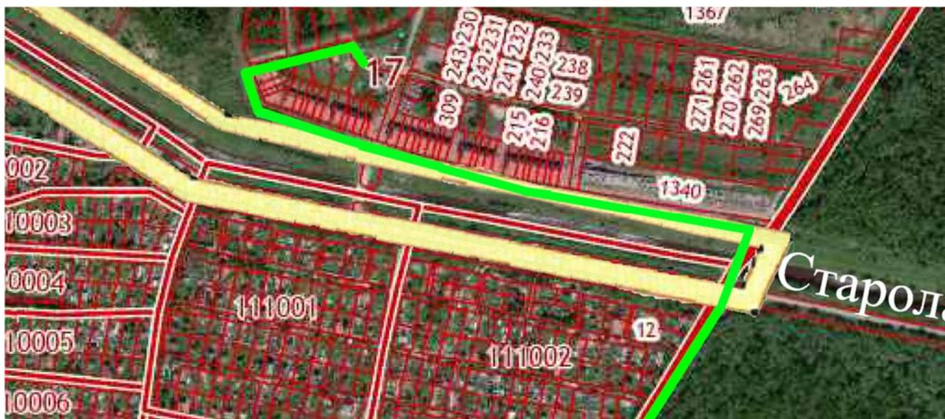
Рис. 11. Совмещение трассы нового газопровода и единых границ ОКН «Комплекс зданий и сооружений на Староладожском канале» и «Комплекс сооружений Петровского канала». Зеленый – трасса газопровода, желтый – границы ЗРЗ 3.
