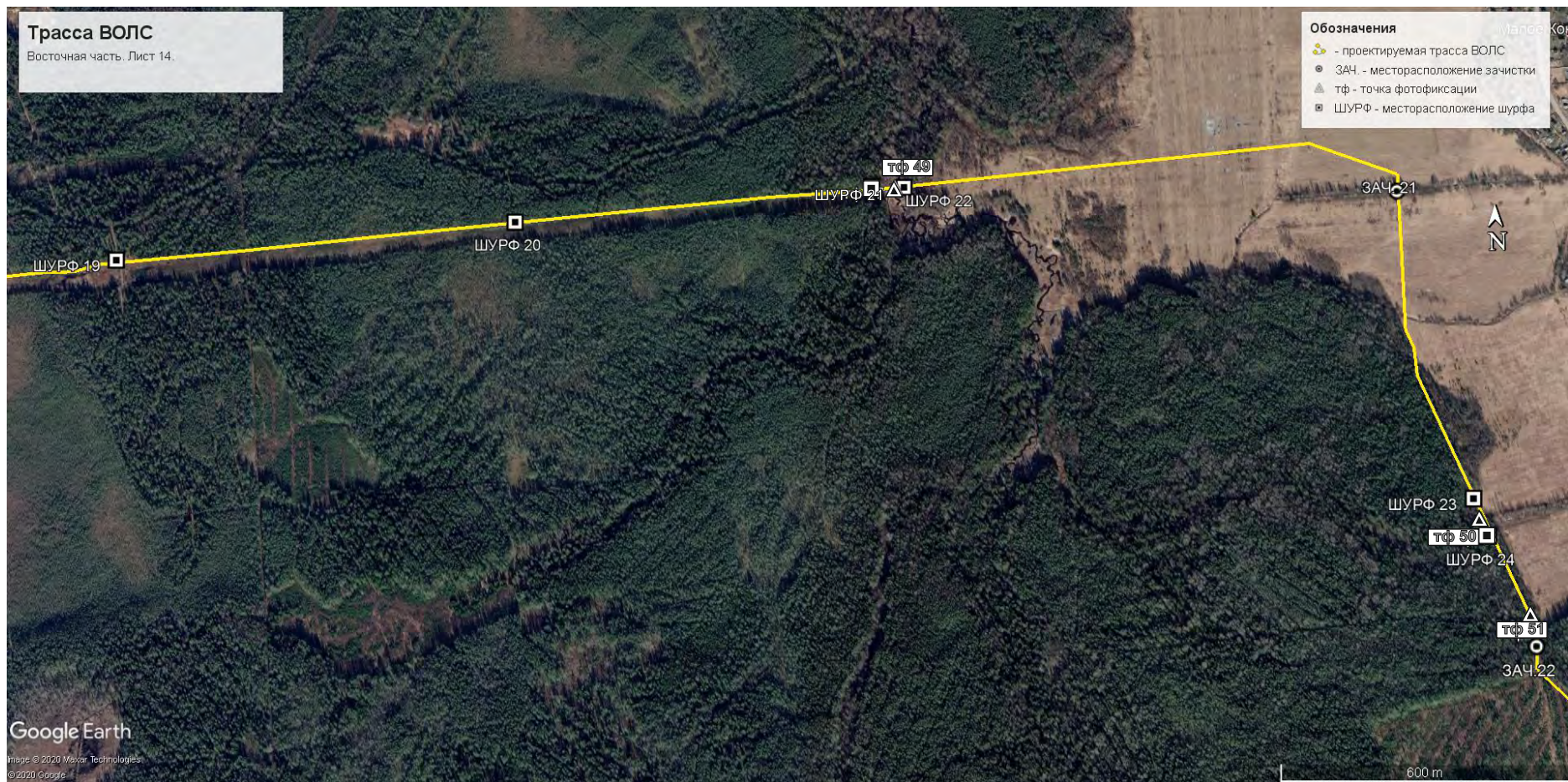
Рис. 32. Ленинградская область, объект «Строительство кабельной волоконно-оптической линии связи мультисервисной транспортной сети связи Балтийского флота в направлении: УС 571-Д – объект 81809». Проектируемая трасса ВОЛС, с нанесенным месторасположением точек фотофиксации (тф), зачисток (ЗАЧ.) и шурфов (ШУРФ). Лист 14.
