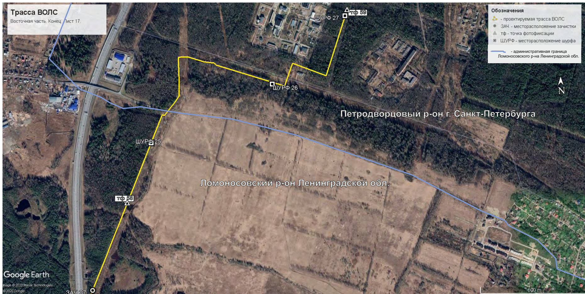
Рис. 35. Ленинградская область, объект «Строительство кабельной волоконно-оптической линии связи мультисервисной транспортной сети связи Балтийского флота в направлении: УС 571-Д – объект 81809». Проектируемая трасса ВОЛС, с нанесенным месторасположением точек фотофиксации (тф), зачисток (ЗАЧ.) и шурфов (ШУРФ). Лист 17.
