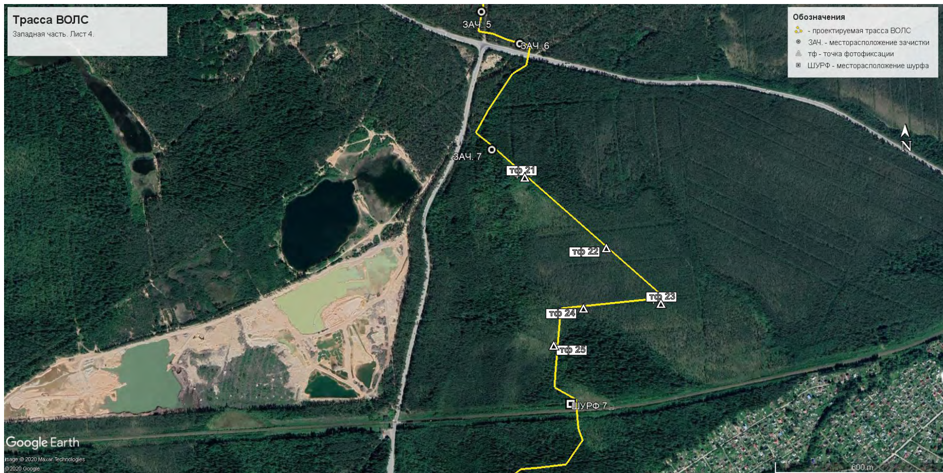
Рис. 22. Ленинградская область, объект «Строительство кабельной волоконно-оптической линии связи мультисервисной транспортной сети связи Балтийского флота в направлении: УС 571-Д – объект 81809». Проектируемая трасса ВОЛС, с нанесенным месторасположением точек фотофиксации (тф), зачисток (ЗАЧ.) и шурфов (ШУРФ). Лист 4.
