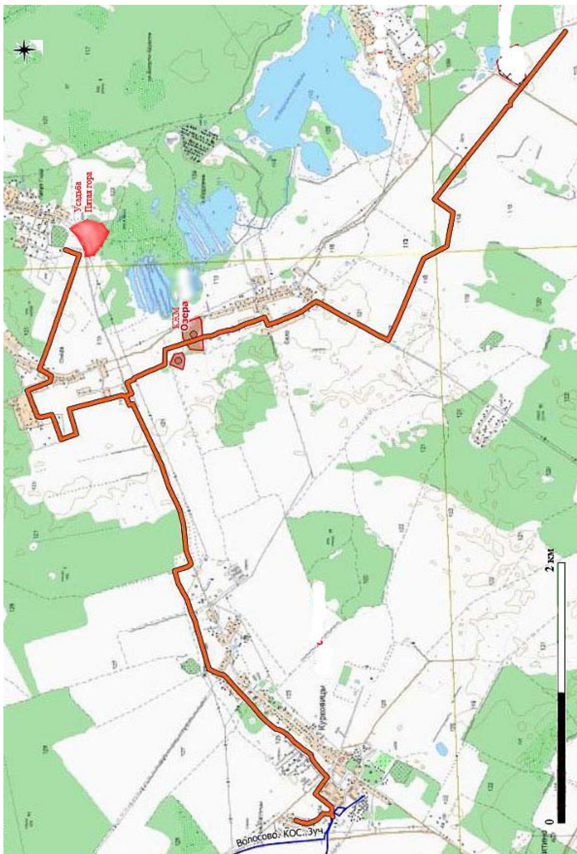
Илл. 3. Ленинградская обл., Волосовский р-н. Принципиальная схема газоснабжения по проектируемому объекту «Межпоселковый газопровод от д. Курковицы до д. Новые Раглицы, д. Озера, д. Пятая Гора с отводами на д. Село, д. Донцо, д. Малое Заречьё» на топографической карте с указанием ОКН.
