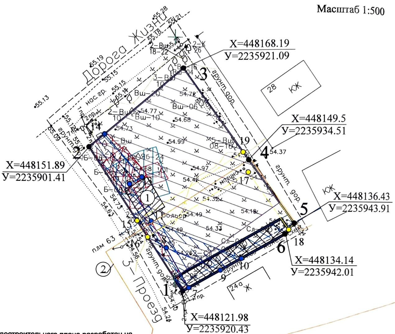
Чертеж градостроительного плана разработан на топографической основе в масштабе 1:500, выполненной в сентябре 2019 г. ООО "Гринвич" Система координат -МСК 47 зона 2 Система высот - Балтийская.
