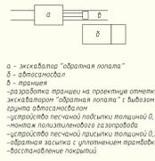
Технологическая схема разработки котлована в стесненных условиях в пределах проектной части дороги экскаватором "обратная лопата" с парковкой грунта в административной зоне.
