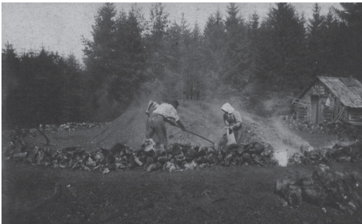
Рис. 12. Ленинградская область, Выборгский район – 2021 г. ОКН «Группа углежогных ям Симагино I», «Углежогная куча Симагино II», «Группа углежогных куч Симагино V», «Углежогная куча Симагино VII». Серия открыток из Шварцвальда конца XIX в. Извлечение угля из кучи.
