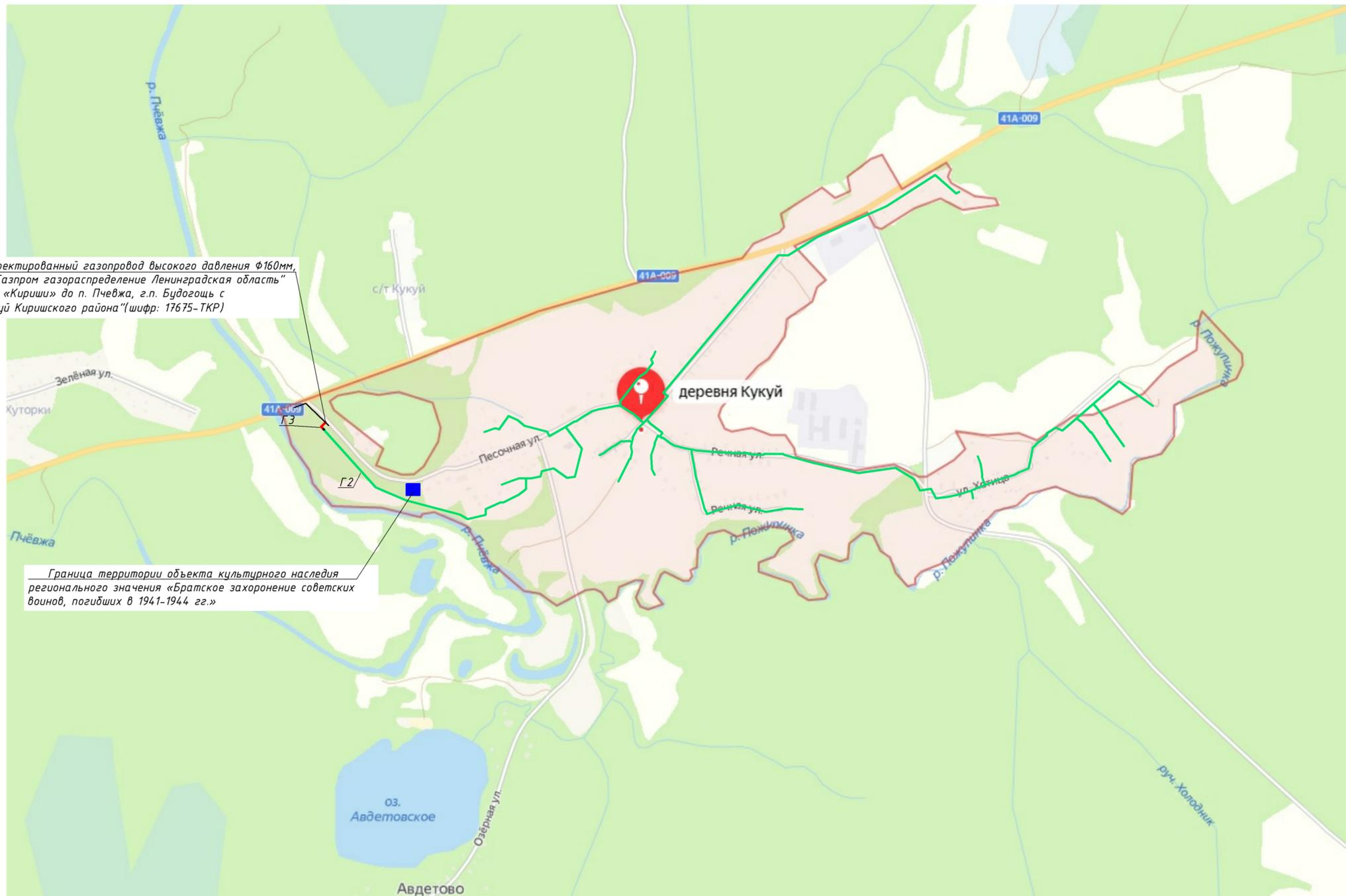
Место присоединения в ранее запроектированный газопровод высокого давления  $\Phi 160\text{мм}$ , выполненный по проекту ПКЦ АО "Газпром газораспределение Ленинградская область" "Газопровод межпоселковый от ГРС «Кириши» до п. Пчѣвжа, г.п. Будогощь с отводами на д. Гремячево и д. Кукуй Киришского района"(шифр: 17675-ТКР)
