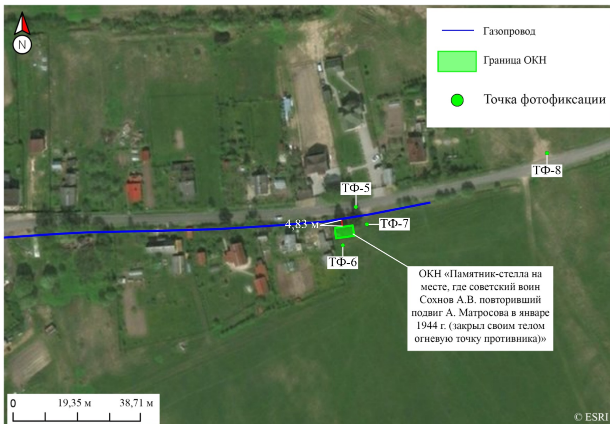
Рис. 4. Взаиморасположение Объекта «Распределительный газопровод по дер. Педлино Гатчинского муниципального района Ленинградской области» и ОКН с указанием расстояния между ними и точек фотофиксации
