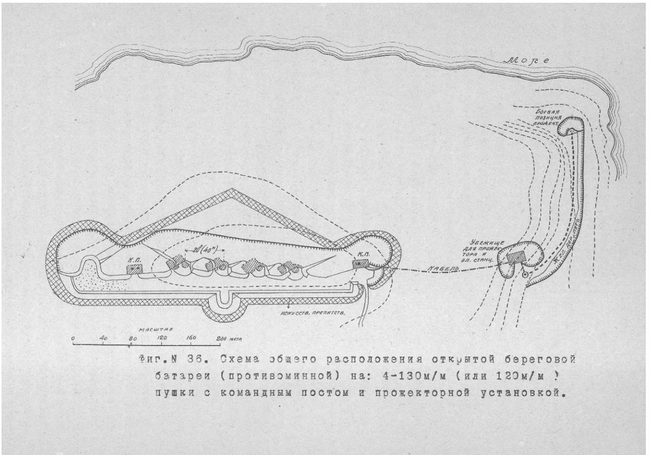
Фиг. № 36. Схема общего расположения открытой береговой батареи (противоминной) на: 4-130м/м (или 120м/м) пушки с командным постом и прожекторной установкой.
