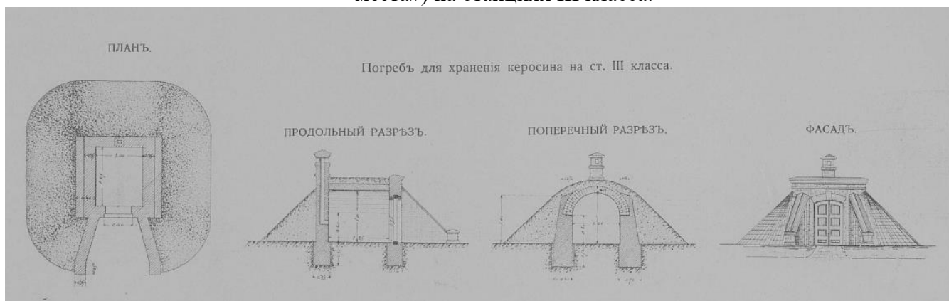
Илл.15. Сооружение С.-Петербурго-Вологодской жел. дороги: Альбом чертежей типовых и исполнительных, 1902-1905. - СПб., 1906. Л. 92. Погребъ для хранения керосина на ст. III класса. Предположительно, по аналогичному проекту выполнялся ледник в составе комплекса построек железнодорожного вокзала на ст. Тихвин.
