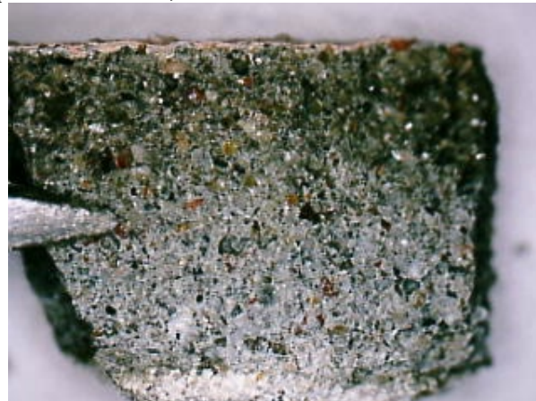
Микроструктура нижнего слоя штукатурной отделки. Ширина поля зрения фото 10 мм
