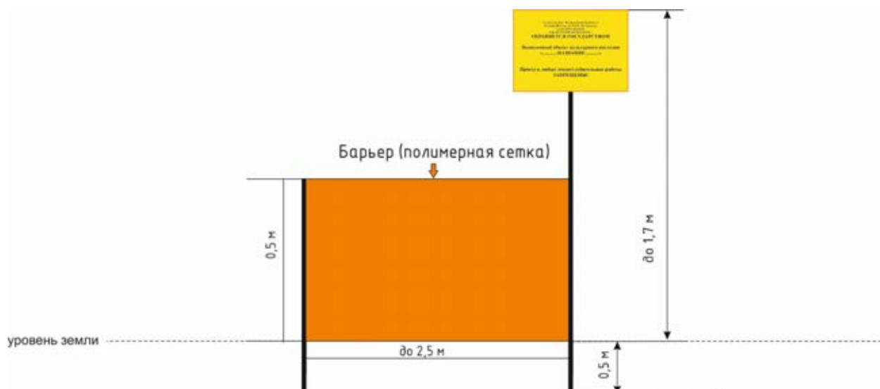
Ограждение объекта культурного наследия (план устройства).
