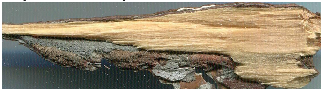
Древесина образца, нижняя поверхность пакета красок. Микрофото. Поле зрения 4,1 x 1,1 см
