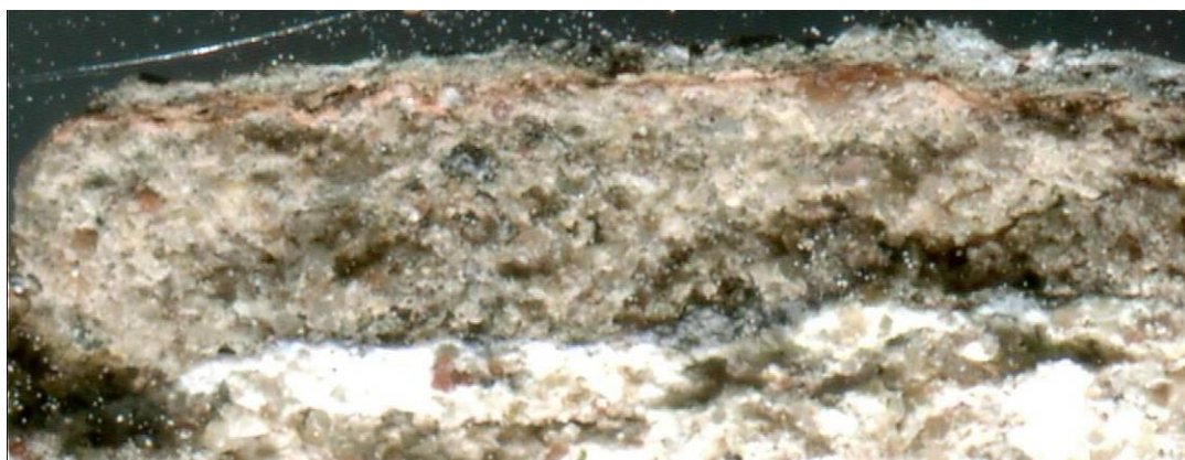
Пакет шпаклевочных и красочных слоев на растворе образца №4.
