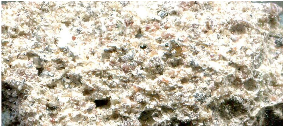
Раствор кладочный образца №2. Микрофото. Поле зрения 1,0 x 2,2 см
