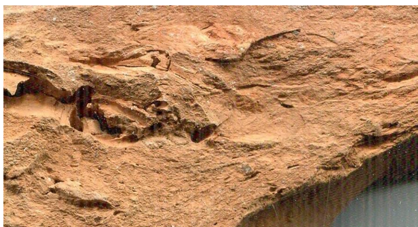
Кирпич образца №1. Микрофото. Поле зрения 4,2 x 2,2 см
