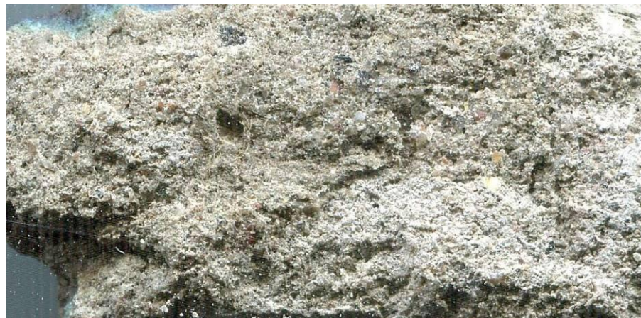
Раствор кладочный образца №3. Микрофото. Поле зрения 1 x 2 см
