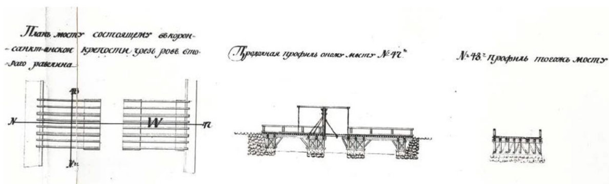
8. План и профили моста через ров второго равелина в Корон-Санкт-Анской крепости во втором равелине. 1798 г. РГВИА. Ф. 349. Оп. 7. Д. 190. (Фотокопия: Архив ВМЗ. № 65). Предоставлено заказчиком.
