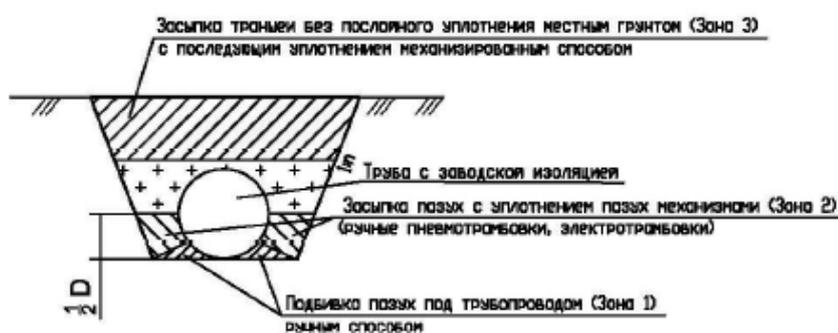
Рис. 7.2 Схема уплотнения грунта обратной засыпки для трубопровода DN и менее с соотношением  $t/D \leq 1/80$  (тонкостенная труба) на землях сельскохозяйственного назначения
