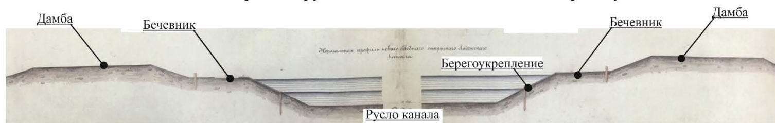
Типовой поперечник русла Новоладожского канала по проекту 1858 г.
