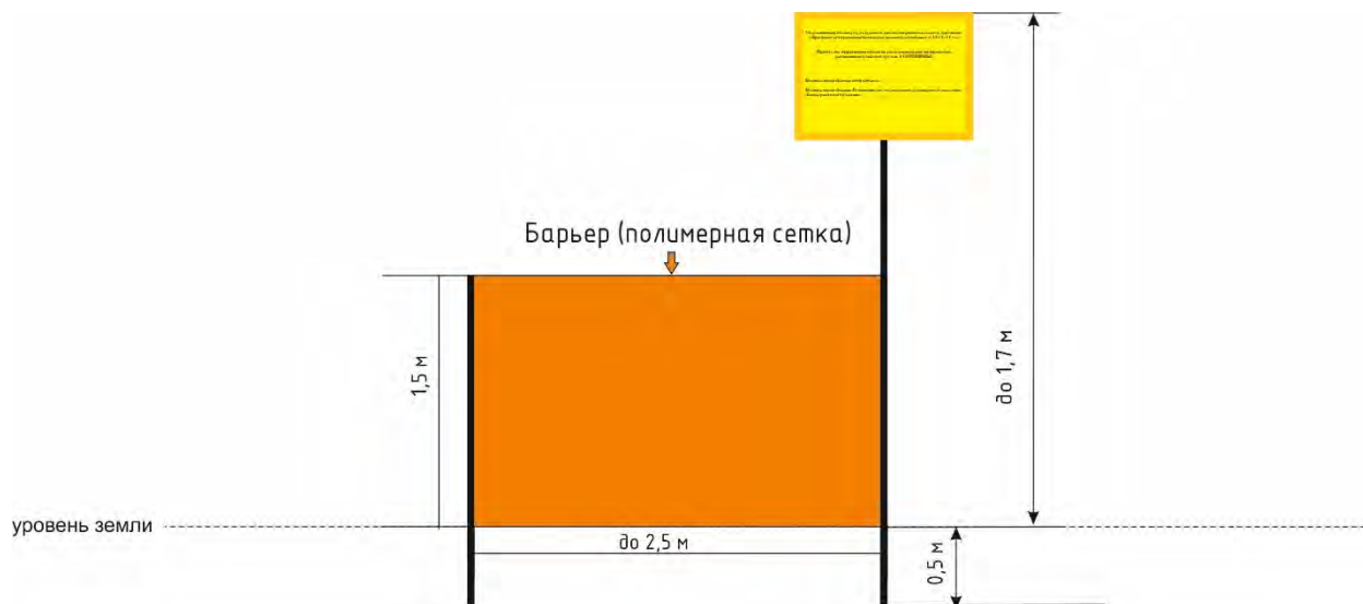
Ограждение объекта культурного наследия (план устройства)
