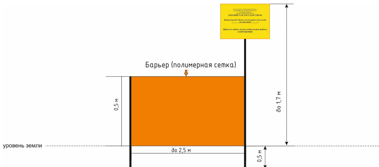
Ограждение объекта культурного наследия (план устройства).
