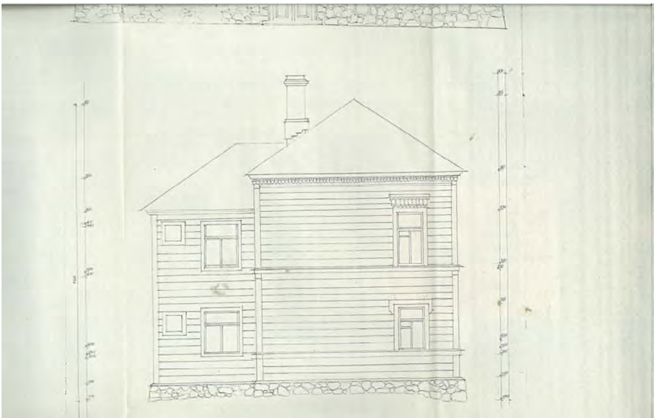
Илл. 54. Обмер северного фасада флигеля (в проекте ошибочно называется усадебным домом). ЛенНИИПградостроительства. 1989 г.
