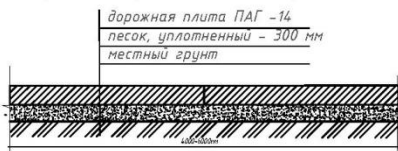
Конструкция временной дороги на площадке строительства
