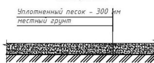
Конструкция площадок складирования
