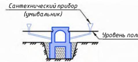
Продольный разрез конструкций отхожего места
