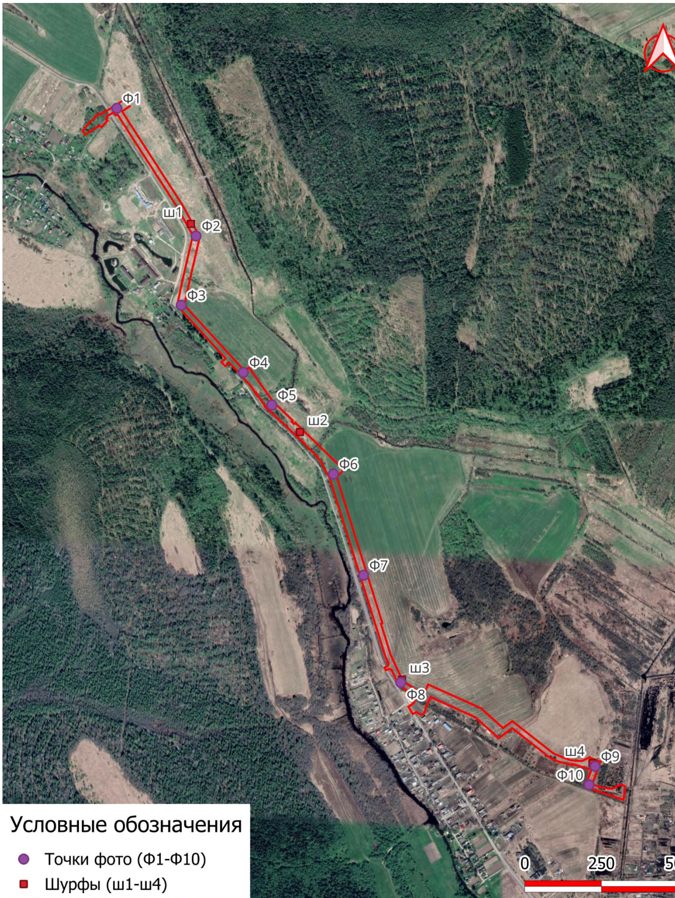
Илл. 5. Фрагмент космоснимка Волховского района Ленинградской Области с наложением прохождения трассы объекта «Межпоселковый газопровод до д. Мякинкино - д. Трусово Волховского района» с указанием точек фотофиксации и мест закладки разведочных шурфов.
