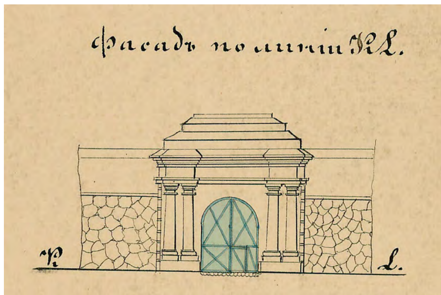
Илл. 22. Чертёж по 1 и 2 Фридрихсгамским и Равелинным воротам одинакового расположения, с показанием произведённой в 1854 г. перестройки воротных полотен и заготовленных заслонных брусьев. Фасад 1-х Фридрихсгамских ворот. 1855 г. Архив чертежей Выборгской крепости и зданий. Kansallisarkisto
