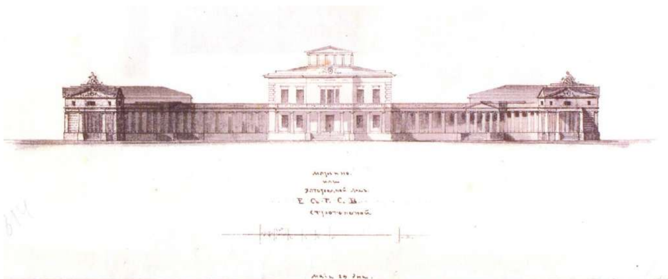
Илл. 2. Южный фасад усадебного дома. Проектный чертеж арх. И.Ф. Колодина, 1814 год. (боковые галереи и торцевые флигели одноэтажные), первый вариант. НИМ РАХ.
