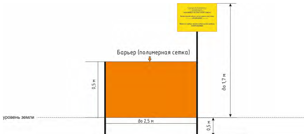
Ограждение объекта культурного наследия (план устройства).
