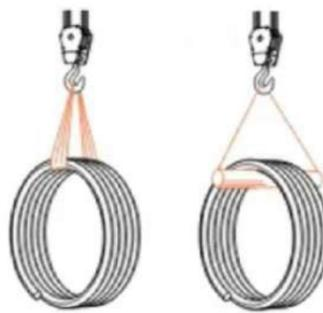
Траверса со стропами с крюками Траверса с текстильными стропами
