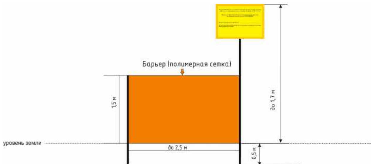
Ограждение объекта культурного наследия (план устройства)
