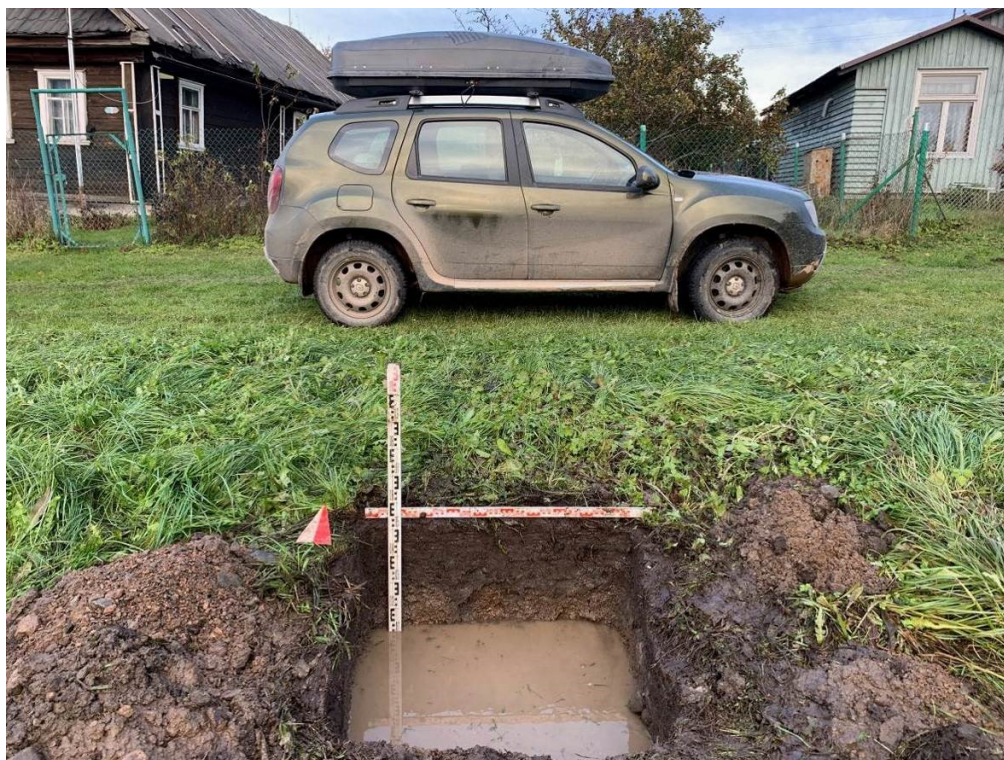
Илл. 55. Ленинградская область, Волховский район. 2024 г. «Газопровод межпоселковый от д. Самушкино – д. Шахново – д. Вороново Волховского района Ленинградской области». Шурф 6. Уровень грунтовых вод. Вид с Ю.
