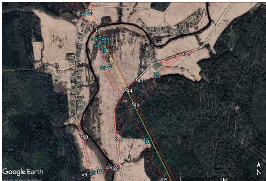
Илл. 307. Ленинградская область, Тосненский район. 2024 г. «Создание высокоскоростной железнодорожной магистрали Санкт-Петербург – Москва (участок Крюково (Алабушево) – Обухово)». «1 этап - Строительство участка Обухово-2 (искл.) - Великий Новгород ВСМ (вкл.)». Проект полосы отвода (красный контур), ось трассы обследования (желтая линия) с ПК628 по ПК651 с указанием точек фотофиксации ЛО-39 – ЛО-50 (белый круг) и мест заложения шурфов ЛО-33 – ЛО-41 (голубой квадрат) на спутниковом снимке Google Earth.
