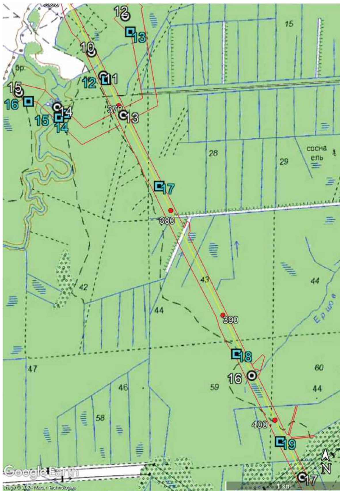
Илл. 89. Ленинградская область, Тосненский район. 2024 г. «Создание высокоскоростной железнодорожной магистрали Санкт-Петербург – Москва (участок Крюково (Алабушево) – Обухово)». «1 этап - Строительство участка Обухово-2 (искл.) - Великий Новгород ВСМ (вкл.)». Проект полосы отвода (красный контур), ось трассы обследования (желтая линия) с ПК362 по ПК406 с указанием точек фотофиксации ЛО-10 – ЛО-17 (белый круг) и мест заложения шурфов ЛО-12 – ЛО-19 (голубой квадрат) на карте ГГЦ.
