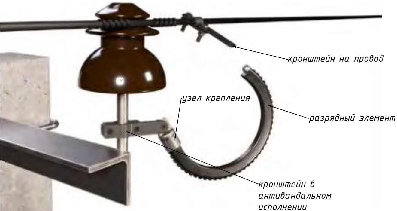
Установка РМК-20-IV-УХЛ1 совместно с натяжной изоляцией
