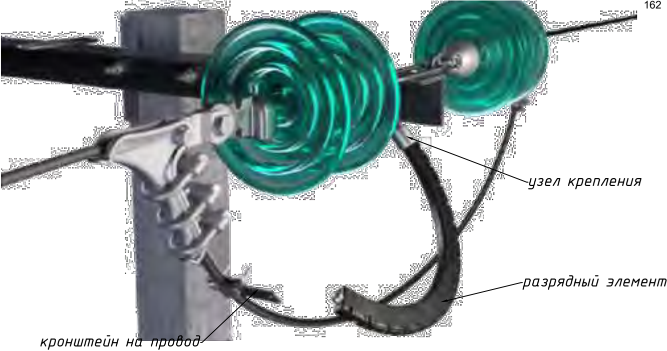
Схема установки РМК-20-IV-УХЛ1 на опорах ВЛ-10 кВ в "шахматном" порядке
