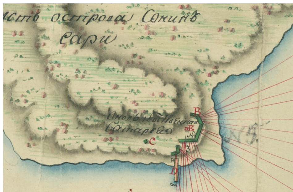
Батарея Суонионсаари после завершения строительства. Экспликация: В – батарея, С – пороховой погреб, Д – причал, Е – печь для каления ядер. 1808 г. Источник: Национальный архив Финляндии.
