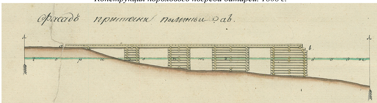
Конструкция пристани у батареи. Фрагмент Генплана. 1808 г.
