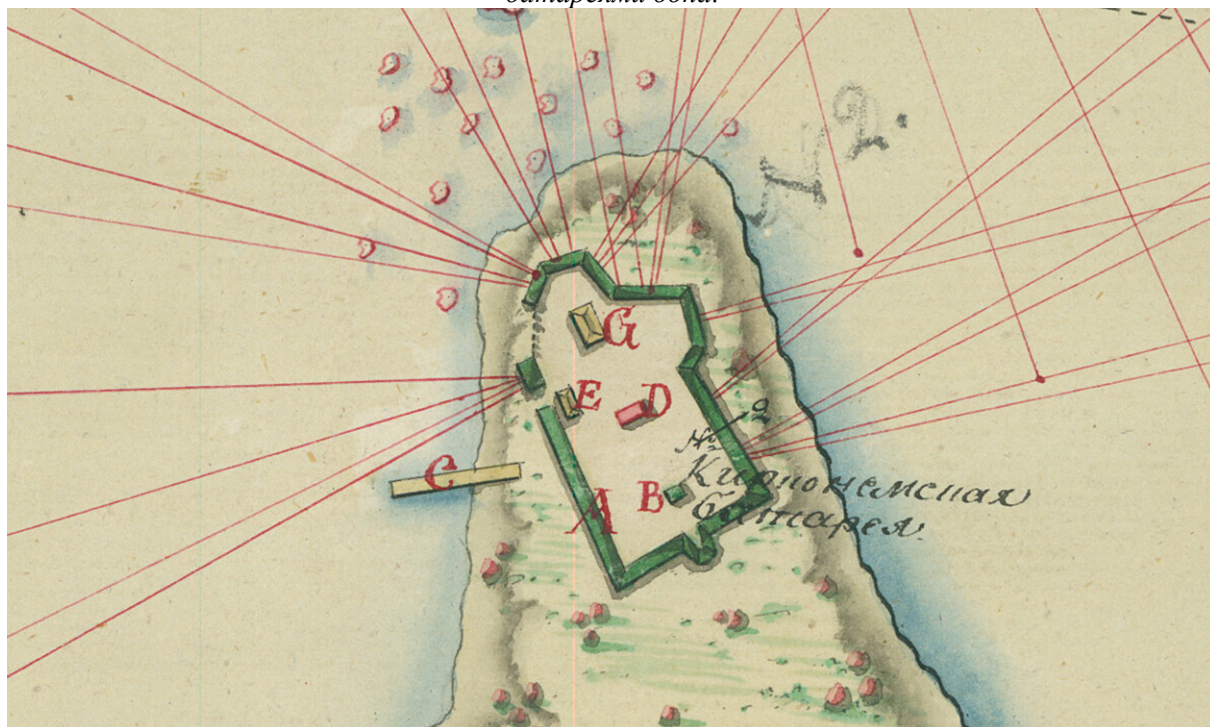
Редут Кирккониеми. Фрагмент Генплана укреплений. Экспликация: А – батарея, В – пороховые погреба, С – пристань, Д – печь для каления ядер, Е – караульный дом, F – бон в проливе, G – таможня. 1808 г. Источник: цифровой фонд Национального архива Финляндии.
