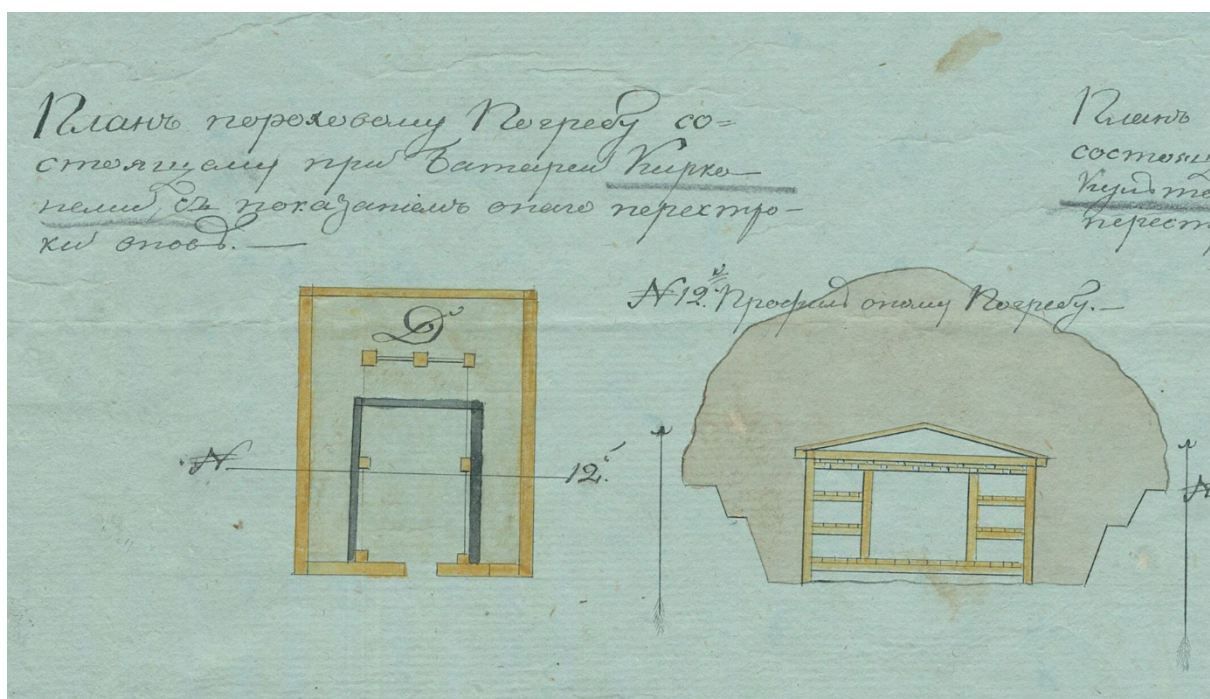
Проект перестройки порохового погреба при батарее Киркониemi. 1811 г. Источник: цифровой фонд Национального архива Финляндии.
