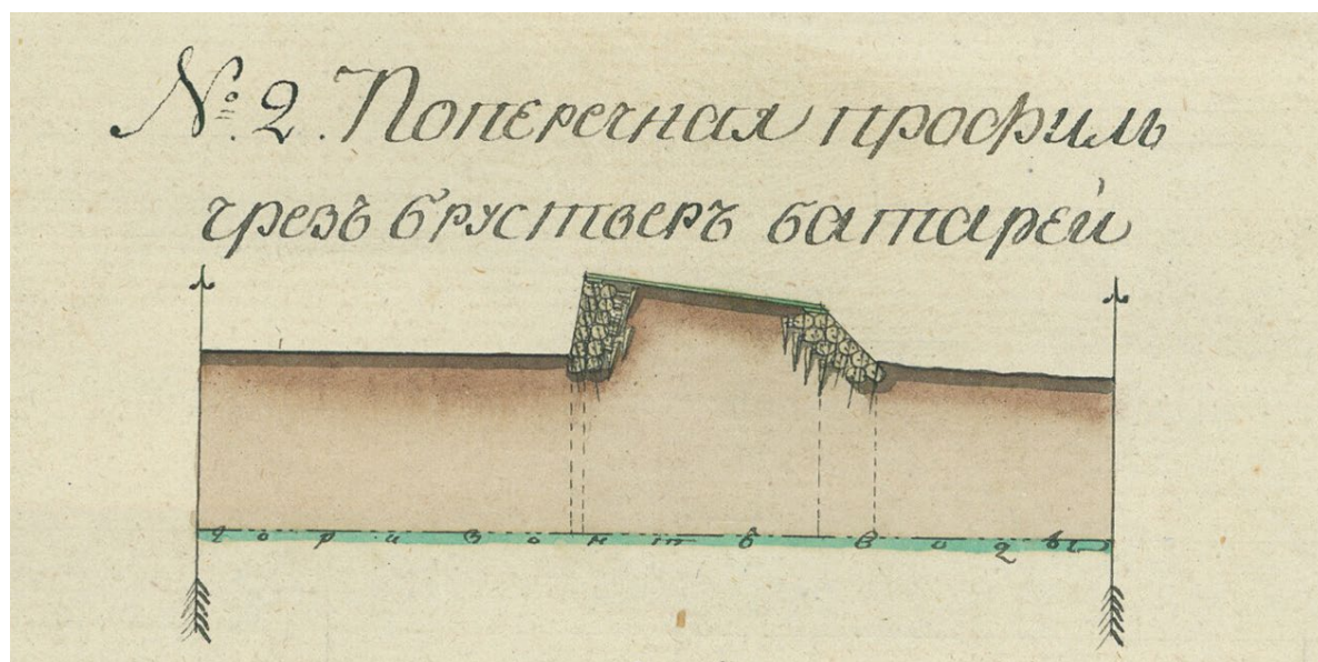
Конструкция бруствера батареи на о.Муста-сари. 1808 г. Источник: Национальный архив Финляндии.
