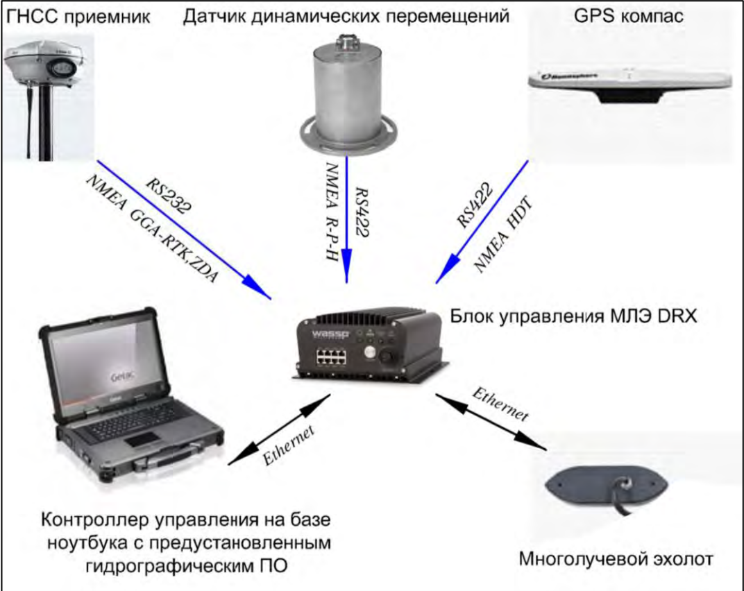
Рисунок 6 - Схема подключения оборудования и налаженных трансляций
