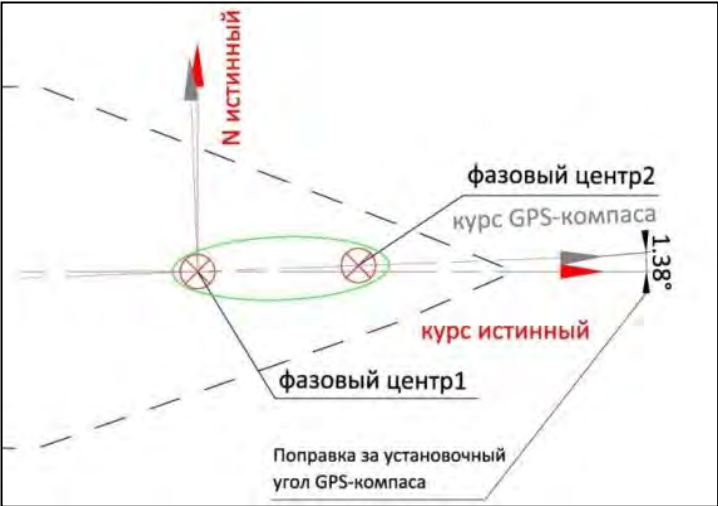
Рисунок 7 - Определение поправки за установочный угол GPS-компаса
