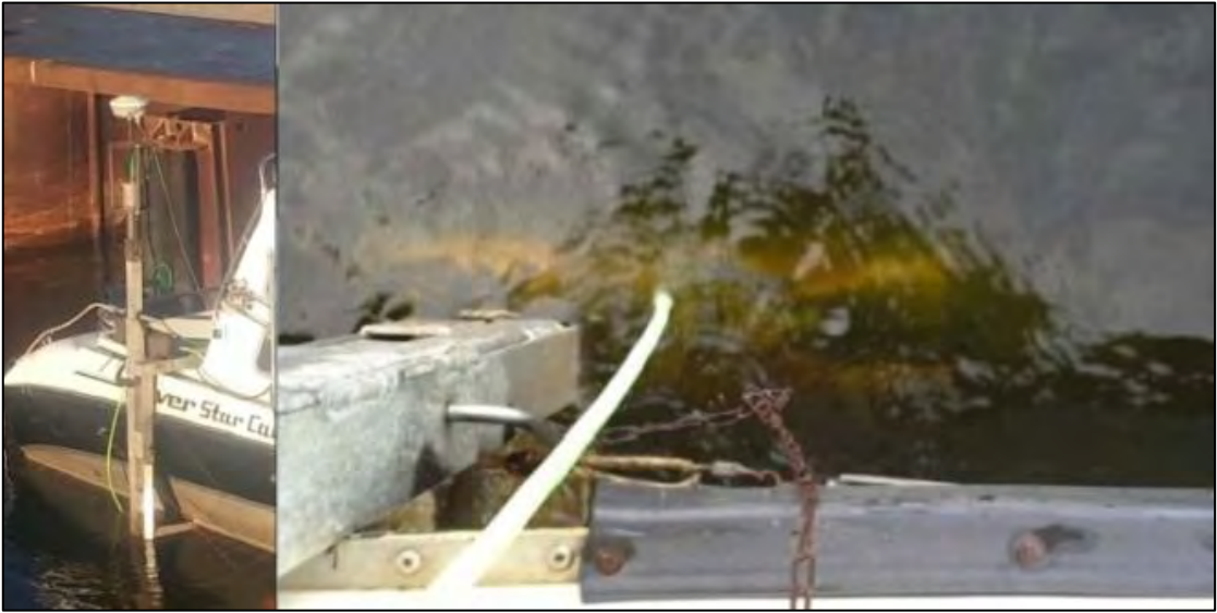
Рисунок 5 - Место установки МЛЭ — установлен на штангу МЛЭ S3 WASSP;
