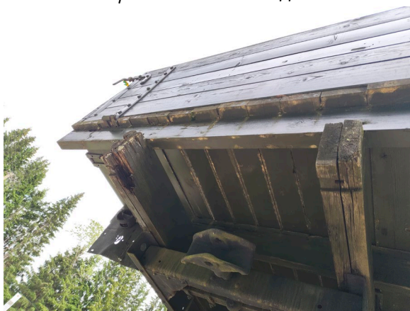
Фото 26. Вид на памятник «Автомашина ЗИС-5». Следы механических повреждений деревянных досок. Дата съемки: июнь 2025. Автор: Шатунова Л.А.
