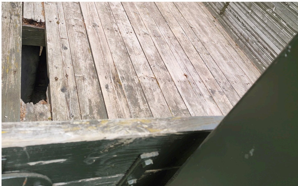
Фото 26. Вид на памятник «Автомашина ЗИС-5». Следы механических повреждений деревянных досок. Дата съемки: июнь 2025. Автор: Шатунова Л.А.
