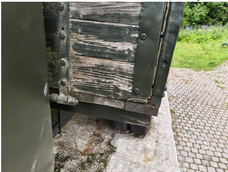
Фото 25. Вид на памятник «Автомашина ЗИС-5». Следы шелушения красочного слоя. Дата съемки: июнь 2025. Автор: Шатунова Л.А.
