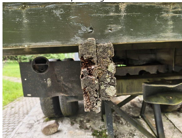
Фото 26. Вид на памятник «Автомашина ЗИС-5». Следы механических повреждений деревянных досок. Дата съемки: июнь 2025. Автор: Шатунова Л.А.
