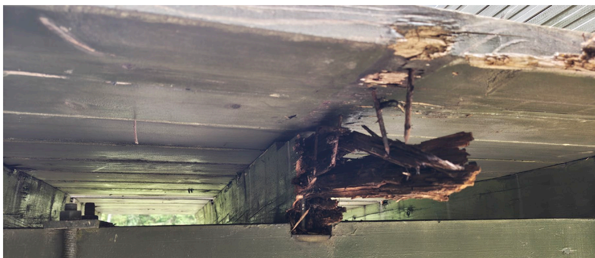
Фото 27. Вид на памятник «Автомашина ЗИС-5». Следы гниения древесины. Дата съемки: июнь 2025. Автор: Шатунова Л.А.
