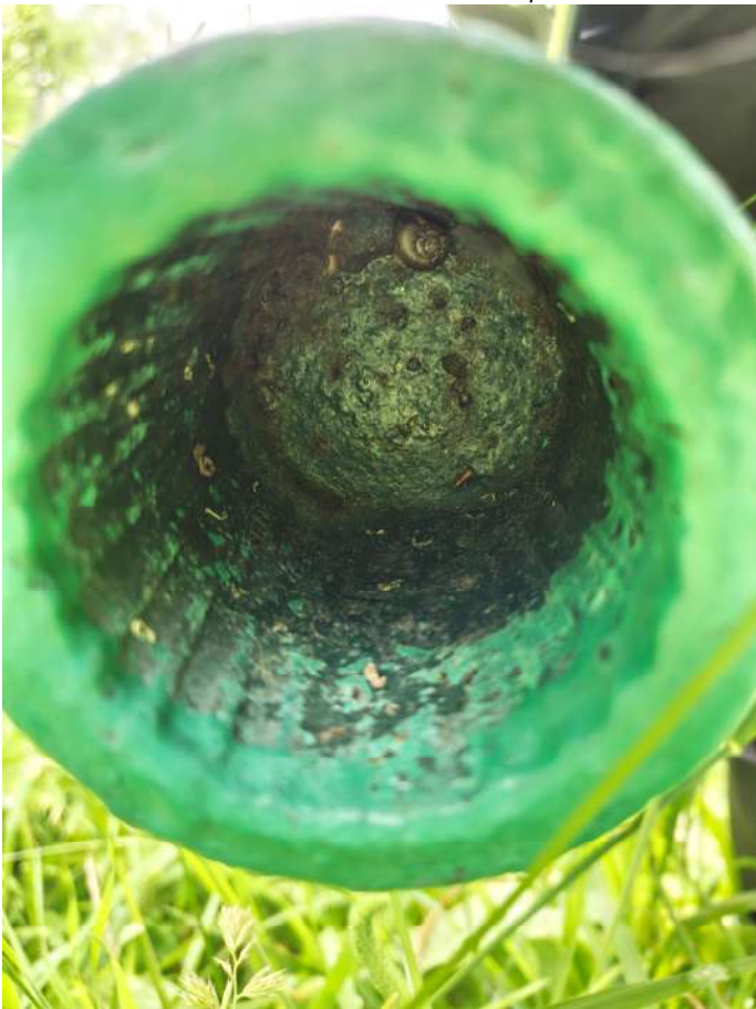
Фото 71. Противотанковая пушка, фрагмент. Следы множественных окрасов, шелушение красочного слоя, следы поверхностной коррозии. Дата съемки: июнь 2025. Автор: Козлова Е.М.
