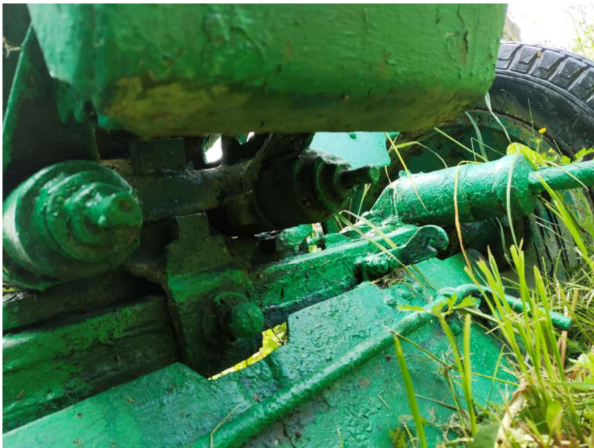
Фото 74. Противотанковая пушка, фрагмент. Следы множественных окрасов, шелушение красочного слоя, следы поверхностной коррозии. Дата съемки: июнь 2025. Автор: Козлова Е.М.
