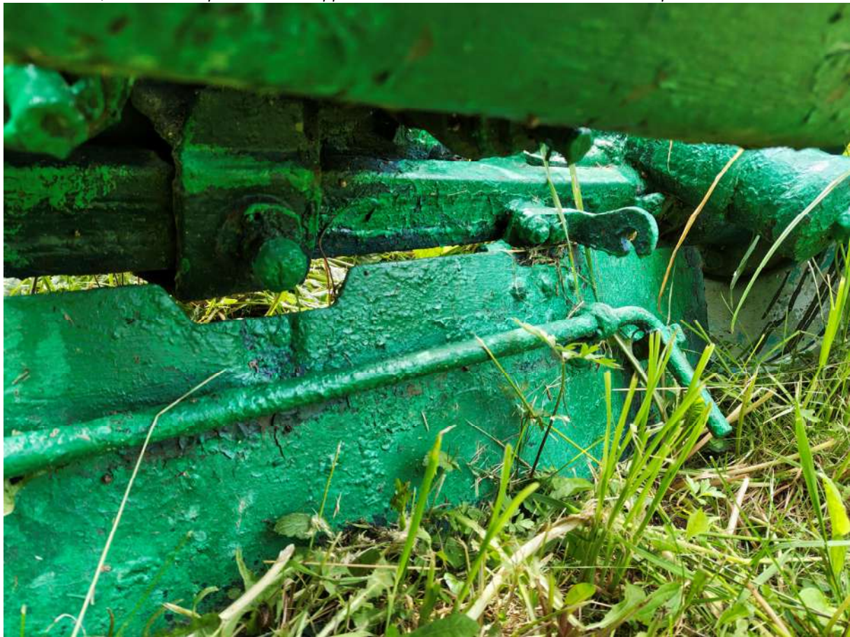
Фото 73. Противотанковая пушка, фрагмент. Следы множественных окрасов, шелушение красочного слоя, следы поверхностной коррозии. Дата съемки: июнь 2025. Автор: Козлова Е.М.
