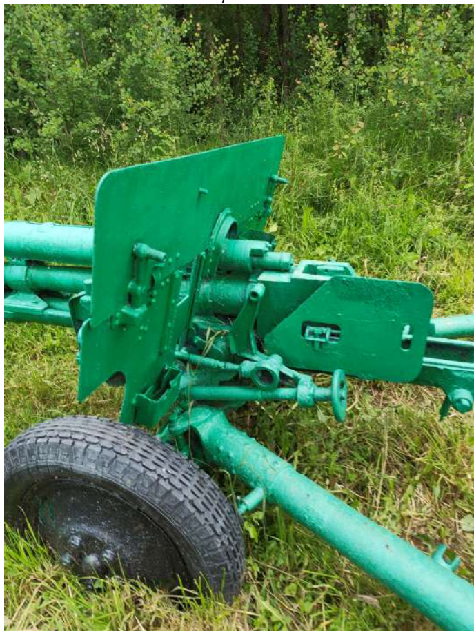
Фото 69. Противотанковая пушка, фрагмент. Следы множественных окрасов, шелушение красочного слоя. Дата съемки: июнь 2025. Автор: Козлова Е.М.
