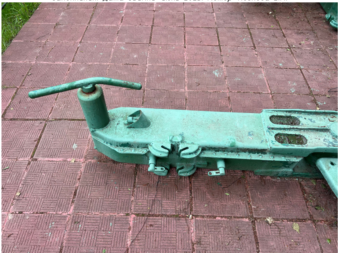
Фото 42. Зенитное орудие. Фрагмент. Шелушение красочного слоя, множественные окрасы, следы поверхностной коррозии, загрязнения. Дата съемки: июнь 2025. Автор: Козлова Е.М.
