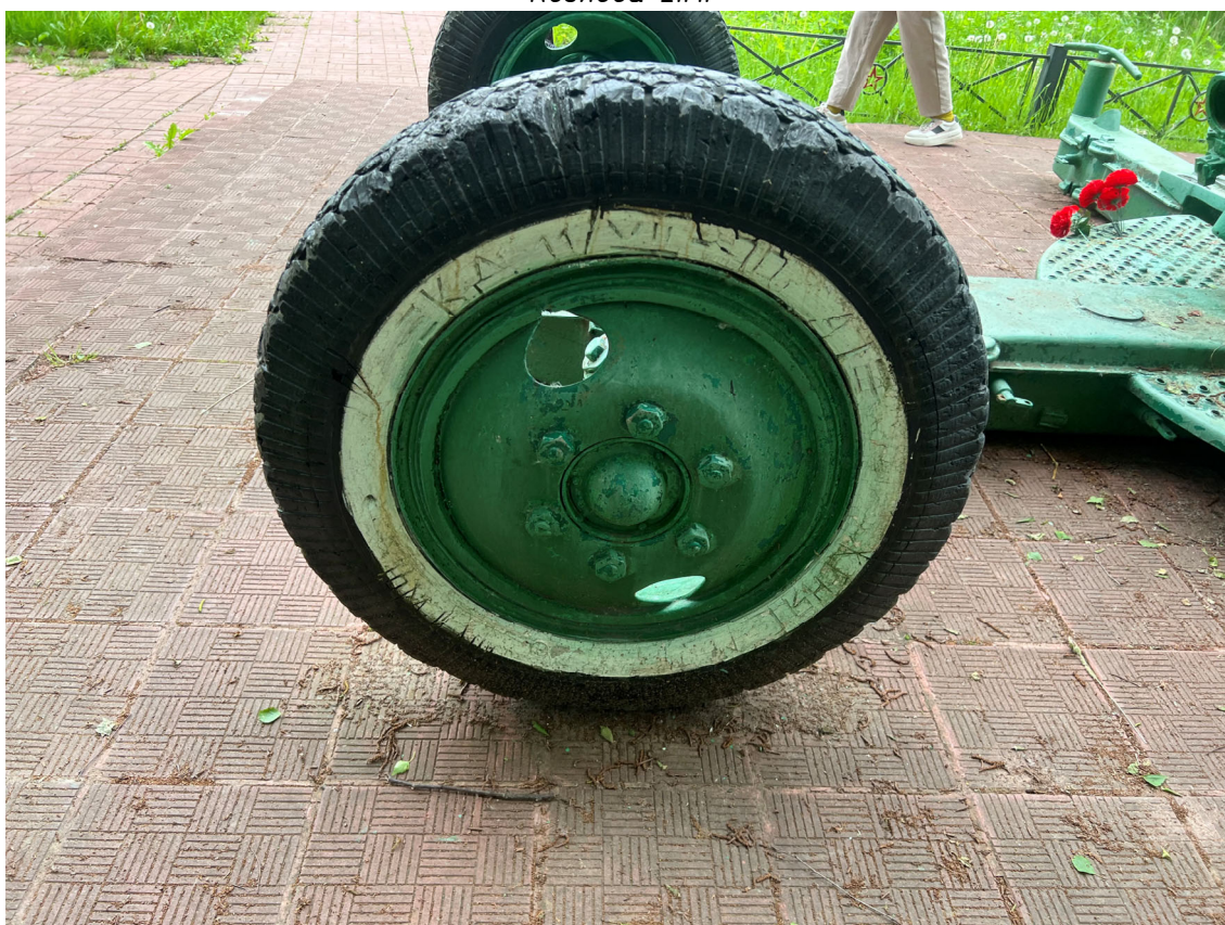
Фото 46. Зенитное орудие. Фрагмент. Механические повреждения, шелушение красочного слоя, множественные окрасы, следы поверхностной коррозии, загрязнения. Дата съемки: июнь 2025. Автор: Козлова Е.М.
