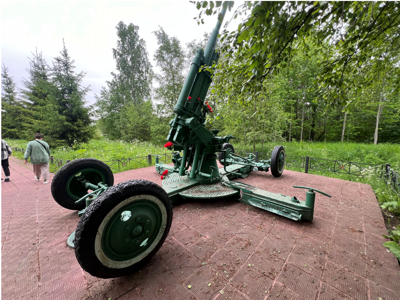
Фото 47. Зенитное орудие. Шелушение красочного слоя, множественные окрасы, следы поверхностной коррозии, загрязнения. Дата съемки: июнь 2025. Автор: Козлова Е.М.
