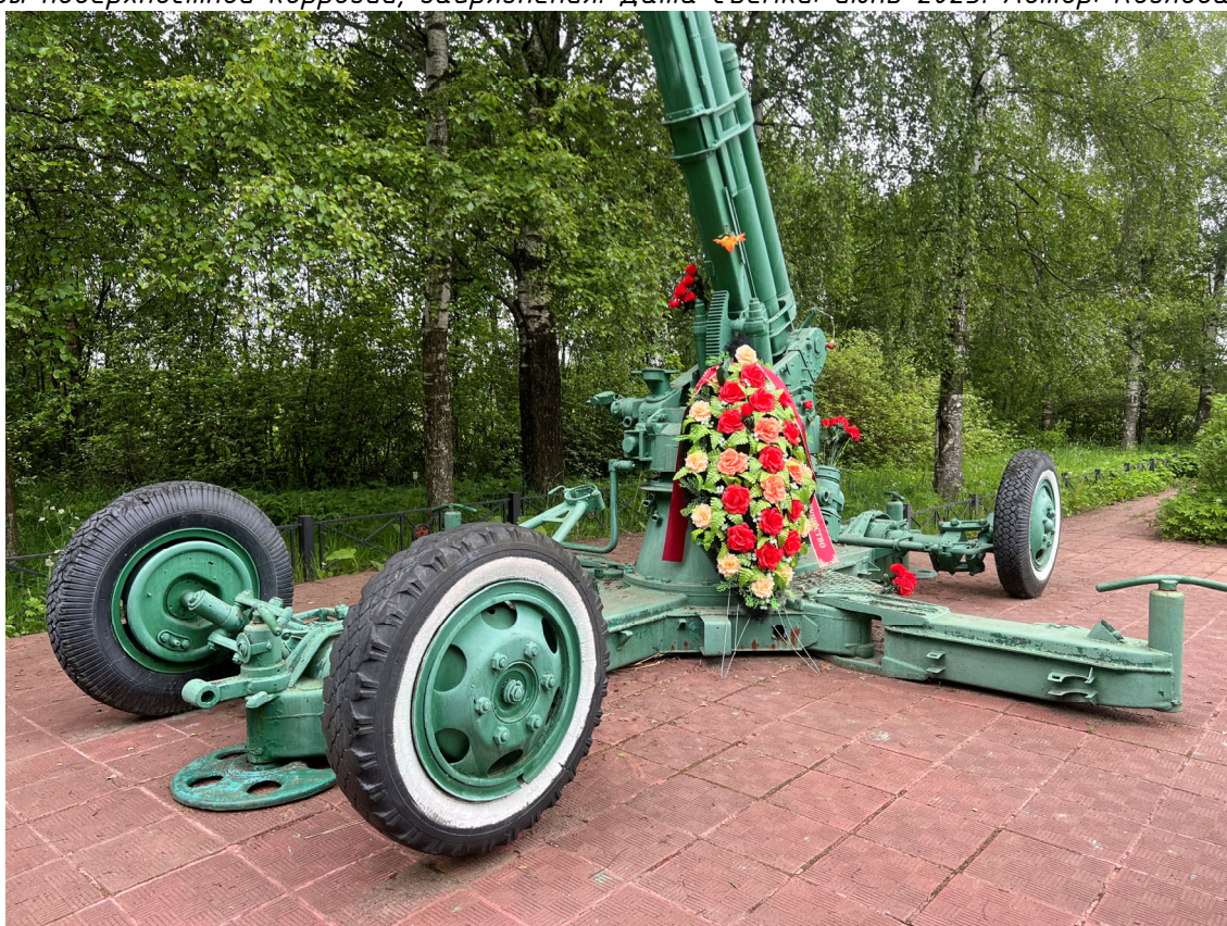
Фото 44. Зенитное орудие. Шелушение красочного слоя, множественные окрасы, следы поверхностной коррозии, загрязнения. Дата съемки: июнь 2025. Автор: Козлова Е.М.
