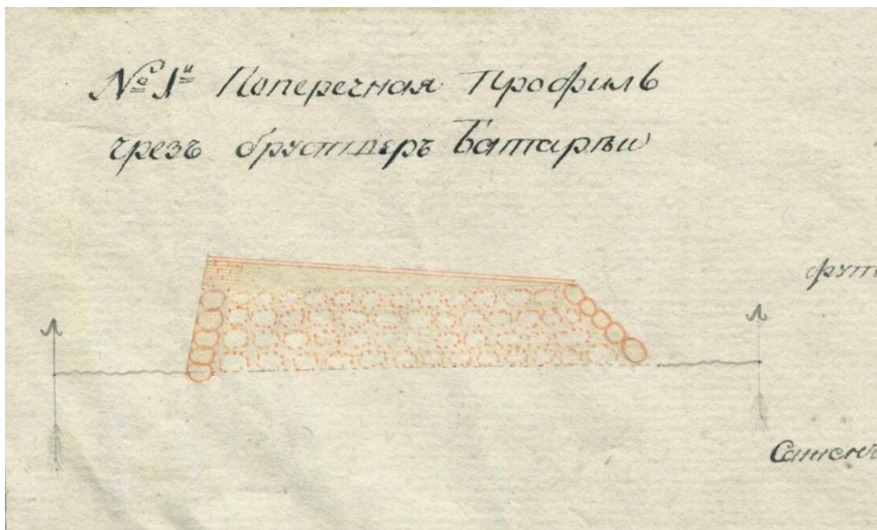
Поперечный разрез бруствера батареи на острове Суонионсаари. Проект. 1808 г. Фрагмент Генеральной карты финляндской губернии. Источник: Национальный архив Финляндии.
