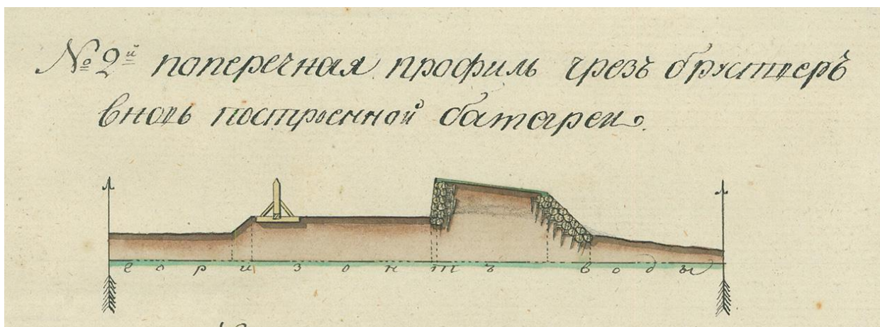
Конструкция бруствера батареи напротив редута Харкисари (2я морская батарея). Фрагмент Генплана. 1808 г.
