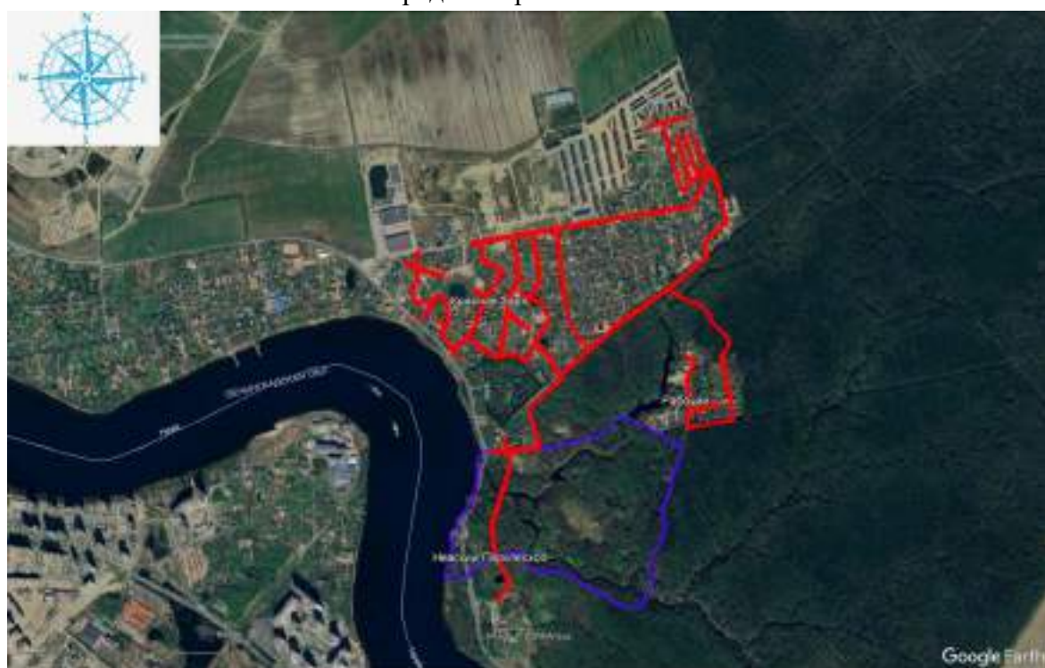
Илл. 10. Схема взаимного расположения трассы проектируемого газопровода (красная линия) и границы территории ОКН «Ансамбль дачи Зиновьева (усадьба «Богословка»), XVIII – XIX века» (синяя линия) на спутниковом снимке (Интернет-сервис Гугл Планета Земля, дата снимка - 08.05.2023 г.).
