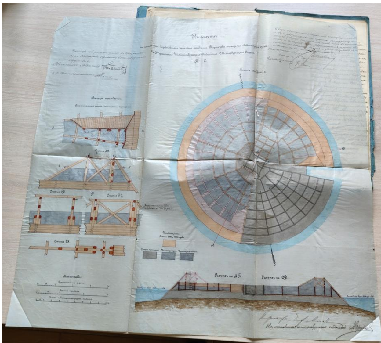
Илл. 21. План к смете на возобновление ряжевого основания на Торпаковом маяке. 1902 г. (источник: ЦГИА СПб. Ф. 921. Оп. 95. Д. 1962).
