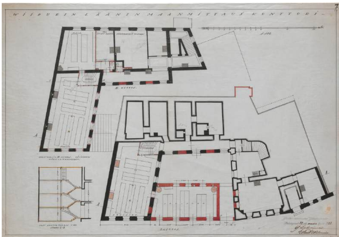
Илл. 23. Проектный чертеж пристройки. Первый этаж. Дата: 1923 г. Автор: Ю. Садениemi, В. Вилениус. Источник:
