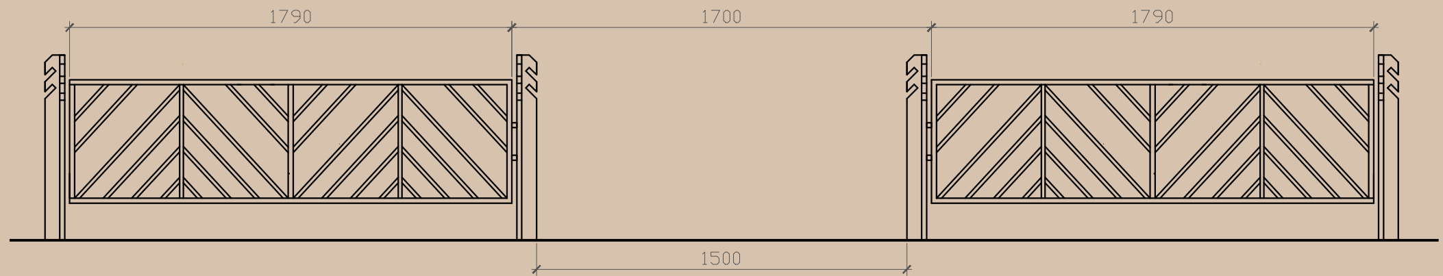
Проектируемое ограждение. Входная зона
