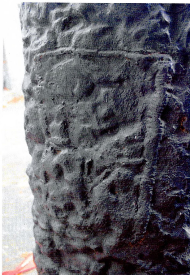
Фото 45 (слева). Фрагмент ствола бронзовой скульптуры. Прямоугольная металлическая заплатка с толстым сварным швом в нижней части ствола. Фото 46 (справа). Фрагмент кроны бронзовой скульптуры. На поверхности металла разрыв с поражением коррозией.
