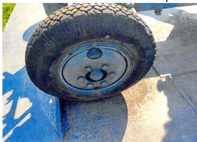
Фото 32-33. Вид на зенитное орудие. Следы механических повреждений металла, биопоражений резины. Следы коррозии металла.
