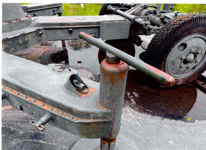
Фото 30-31. Вид на зенитное орудие. Следы антропогенных загрязнений, отслоения красочного слоя.
