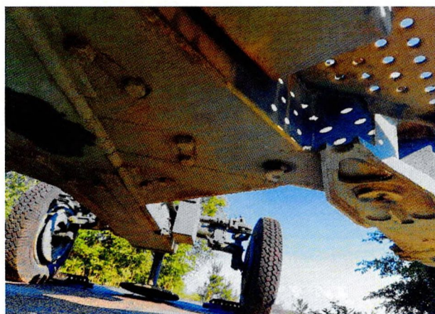
Фото 32-33. Вид на зенитное орудие. Следы механических повреждений металла, биопоражений резины. Следы коррозии металла.
